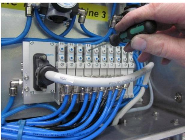
**Illustration 2-8** Îlot de vannes, commande auxiliaire
