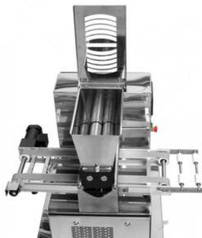
La dresseuse vient équipée d'une tête de dosage avec une trémie de 13 litres, permettant de passer les pâtes molles (pâte à choux, meringues, biscuits, ...) Les rouleaux de 60 mm de diamètre sont en acier inoxydable AISI 304.
